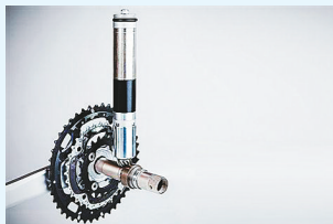
藏在座管内的电机通过齿轮驱动牙盘。
