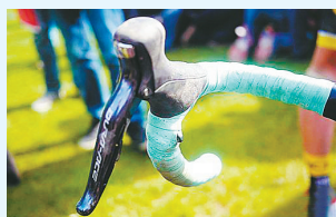
控制开关装在车把,在胶布掩护下不易暴露。
