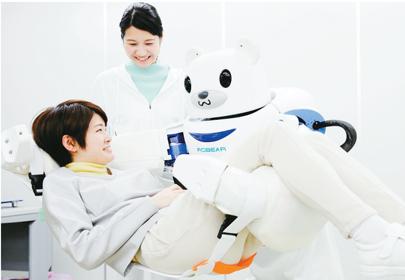
图中机器人叫“保姆机器熊”,它能将行动不便的病人从轮椅上抱起并转移到床上或浴室。
