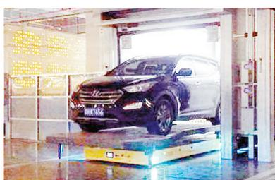
汽车底下的扁平长方形物件就是停车机器人。
