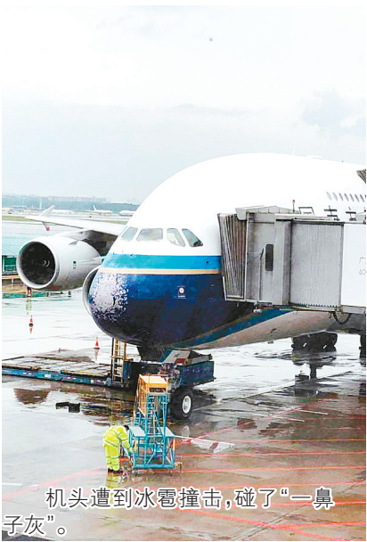
遭到冰雹撞击后的驾驶舱侧面风挡玻璃。
