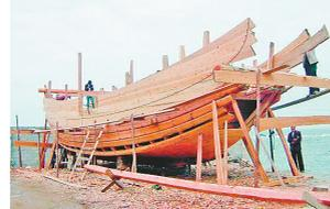
中国水密隔舱福船制造技艺是福建沿海木船制造的一项重要民族传统手工技艺,采用榫接、舱缝等核心技术,使船体结构牢固,舱与舱之间互相独立,形成密封不透水的结构形式。
