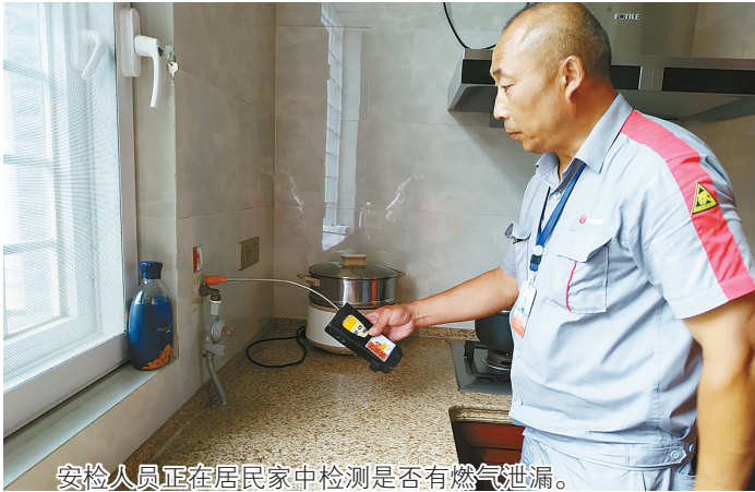
安检人员正在居民家中检测是否有燃气泄漏。
