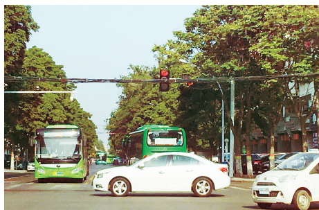
海河路与舟山路交叉口西侧的红绿灯被树枝遮挡。
