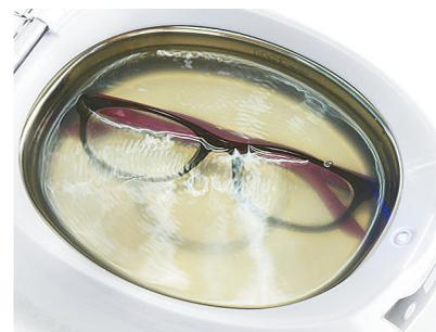
超声波清洗眼镜的原理是利用超声波在液体中的空化作用、加速度作用及直进流作用,对液体和污物直接、间接的影响,使污物层被分散、乳化、剥离,而达到清洗目的。简单说来,就是超声波可以每秒数以万计的高速振动在液体中传导,在水中形成微观强烈冲击波和高速射流,不断作用于清洁用水以及眼镜表面。此时,眼镜表面以及镜框缝隙处积累的污渍会因为受到高频震动而逐渐被震碎,进而和镜片以及镜框分离。不仅如此,超声波的震动也有利于清洗剂将眼镜上的一些污染物清除掉,例如油状污渍等。
