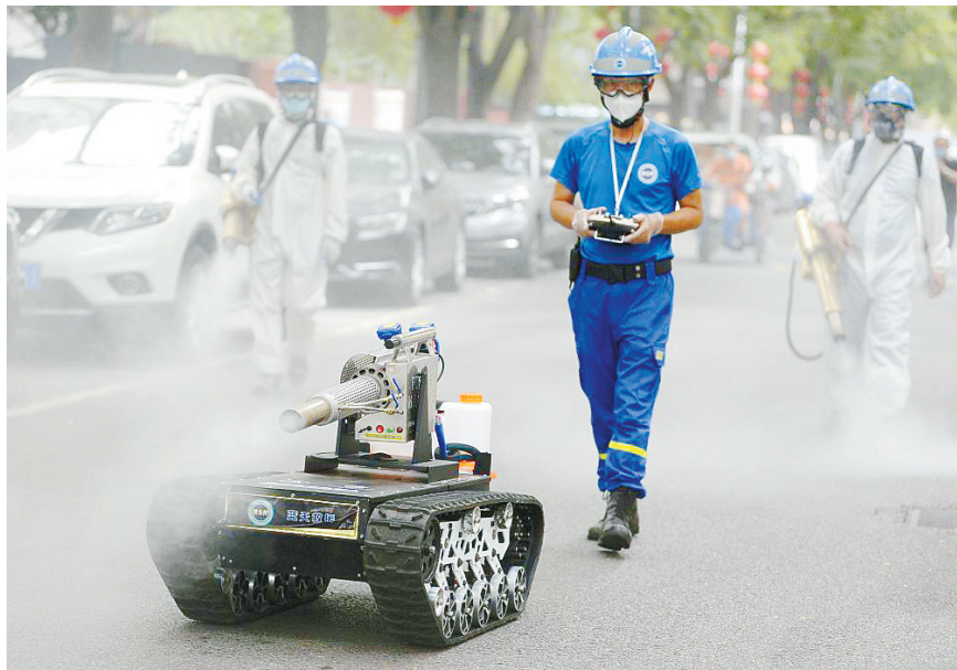
2020年6月29日下午,由中国航天科工集团航天技术研究院综合保障中心设计制造的“防疫消杀机器人”亮相北京丰台区北大街的道路上。消杀机器人形似小坦克,喷雾量大,每小时行进5公里,每小时可以进行10000平方米消杀,负载15L大容量药壶。
