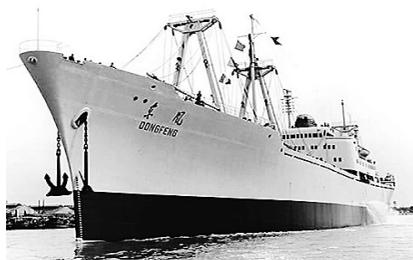
我国自行设计、自行建造的第一艘万吨级远洋货轮——“东风号”, 4月15日在上海江南造船厂下水。“东风号”排水量17182吨, 载重量11642吨, 载货量10000吨, 每小时航速17.3海里, 能在海上连续航行40昼夜, 从上海出发, 经太平洋、印度洋、大西洋, 沿途不加燃料可直达英国伦敦。2008年, 为纪念郑和下西洋600周年开展的“十大名船”评选揭晓, “东风号”名列其中。
