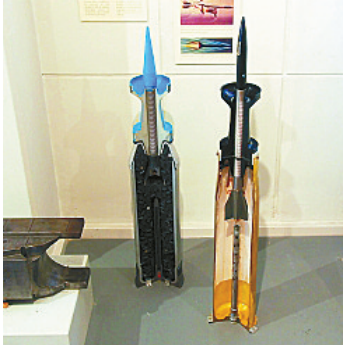
穿甲弹的弹芯用钨合金制造。
